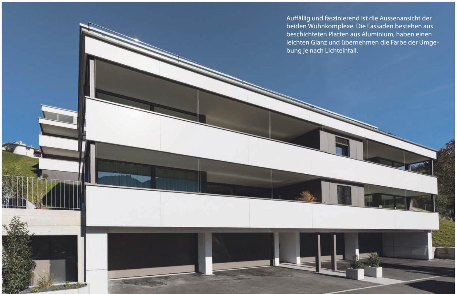
Auffällig und faszinierend ist die Aussenansicht der beiden Wohnkomplexe. Die Fassaden bestehen aus beschichteten Platten aus Aluminium, haben einen leichten Glanz und übernehmen die Farbe der Umgebung je nach Lichteinfall.
